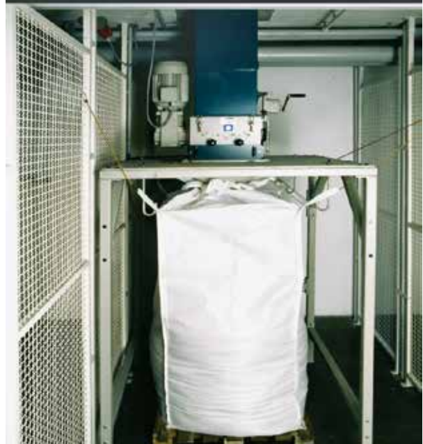
Beistellmühle für PP Mahlgut auf zwei Etagen
